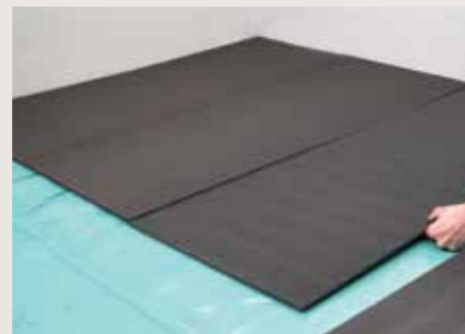
QUICKHEAT-ISOLATIEPLATEN Isolatieplaten. 120 x 50 x 0,7 cm. 10 platen/verpakking. 0,6 m 2 /plaat, 6 m 2 /verpakking. Dikte: 7 mm. Het gebruik van een dampscherm is aanbevolen. Plaats PE-folie PGUSCRSCREEN34 onder QuickHeat-isolatieplaten en ook op QuickHeat-folies.
