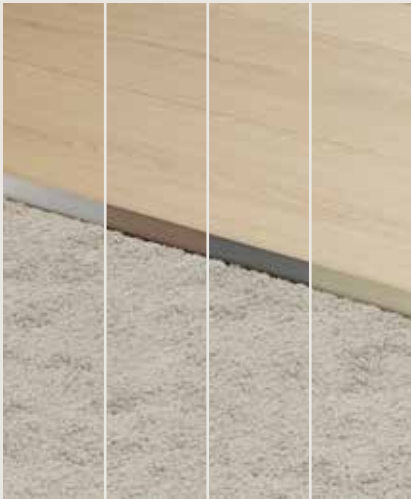
EINDPROFIEL 2000 × 24 × 7 mm Om de uitzettingsvoeg tussen de vloer en bijvoorbeeld een muur, raam of drempel af te dekken. Toplaag: aluminium. Verkrijgbaar in verschillende kleuren: Zilver, Koffie, Klei en Champagne.
