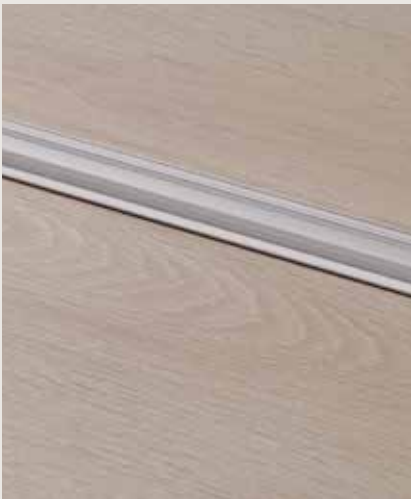
MULTIFUNCTIONEEL PROFIEL ZILVER 1860 × 47 × 16 mm Het multifunctionele profiel van Pergo werkt hoogteverschillen weg en zorgt zo voor een soepele overgang naar elk ander type vloer. Geschikt voor hoogteverschillen van 0 – 12,3 mm. Toplaag: aluminium.
