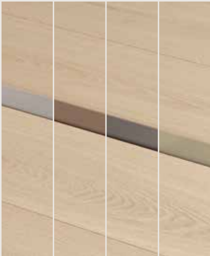
UITZETTINGSPROFIEL 2000 × 34 × 7 mm Om de uitzettingsvoeg tussen twee vloeren met dezelfde hoogte af te dekken. Toplaag: aluminium. Verkrijgbaar in verschillende kleuren: Zilver, Koffie, Klei en Champagne.
